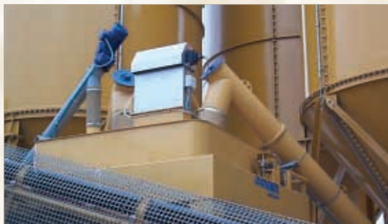
Weigh hopper loaded by screw feeder Behälterwaage mit Dosierschnecke Doseur alimenté par transporteur à vis Dosatore alimentato da coclea
